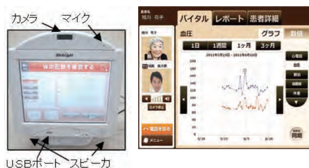
図9 左は装置の外観、右は画面の一例
